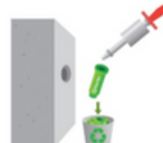
#4 RivePipe zur späteren Wiederverwendung in den Eimer legen
